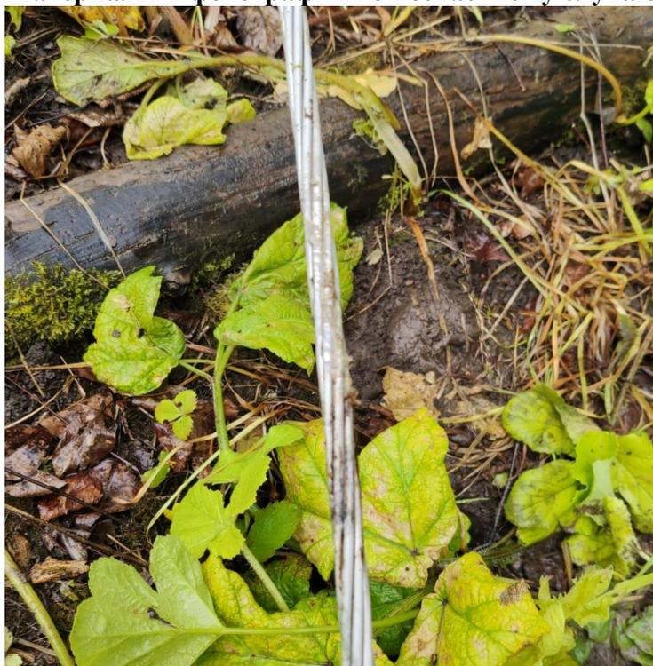
Оборванный неизолированный провод со следами электродугового перекрытия
